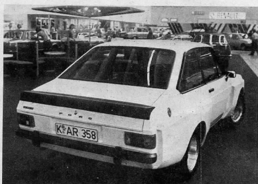
Una vista posteriore di un adattamento con parafanghi allargati e spoiler posteriore della ormai nota Ford Escort 2 litri
