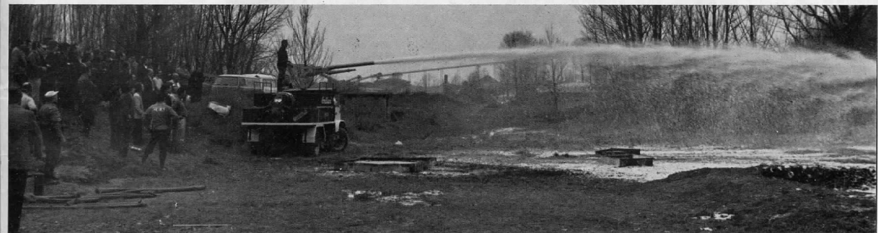
Il «cannone» lanciaschiuma all'opera. Il rogo di 200 litri di benzina, più 100 di speciale liquido ad alta infiammabilità è stato spento in 25/30"
