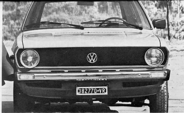
La Volkswagen Polo è la novità più attesa del Salone di Ginevra. Si tratta in pratica della versione VW della Audi 50 di cui mantiene l'impostazione tecnica montando però un motore (sempre anteriore) di 900 cc e 40 CV-DIN
