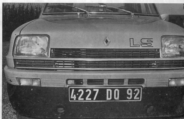
Il vistoso spoiler che equipaggia le Renault R5 « kit ». Vi si notano i fori per il raffreddamento dei freni anteriori. I pneumatici saranno i Dunlop
