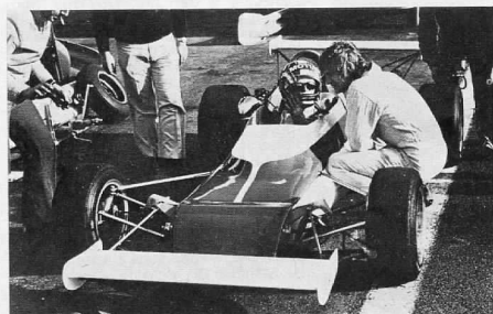
L'interessante Hampe per F. Super Renault. Anteriormente è dotata di un sistema di sospensioni a flessibilità variabile
