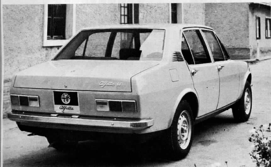
L'Alfetta 1600 ha un motore di 1570 con 125 CV SAE a 5600 giri. Sotto, la versione «Lusso» dell'Alfasud quattroporte. Organi meccanici invariati
