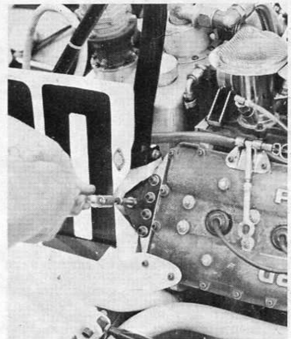
Merzario ha dovuto interrompere le prove, nel momento favorevole, per la rottura di entrambi gli attacchi del motore, documentata nelle foto
