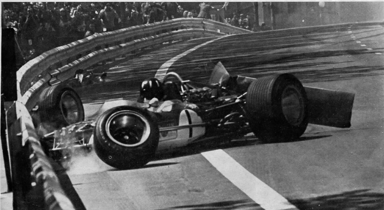
Hill distrugge la sua Lotus 49 contro i guard-rails del Montjuich, nel corso del Gran Premio di Spagna 1969. L'episodio, notissimo, è dipeso dalla rottura dei supporti dell'alettone, straordinariamente simile a quello occorso alla vettura di Stommelen, quest'anno, iscritta da Graham Hill
