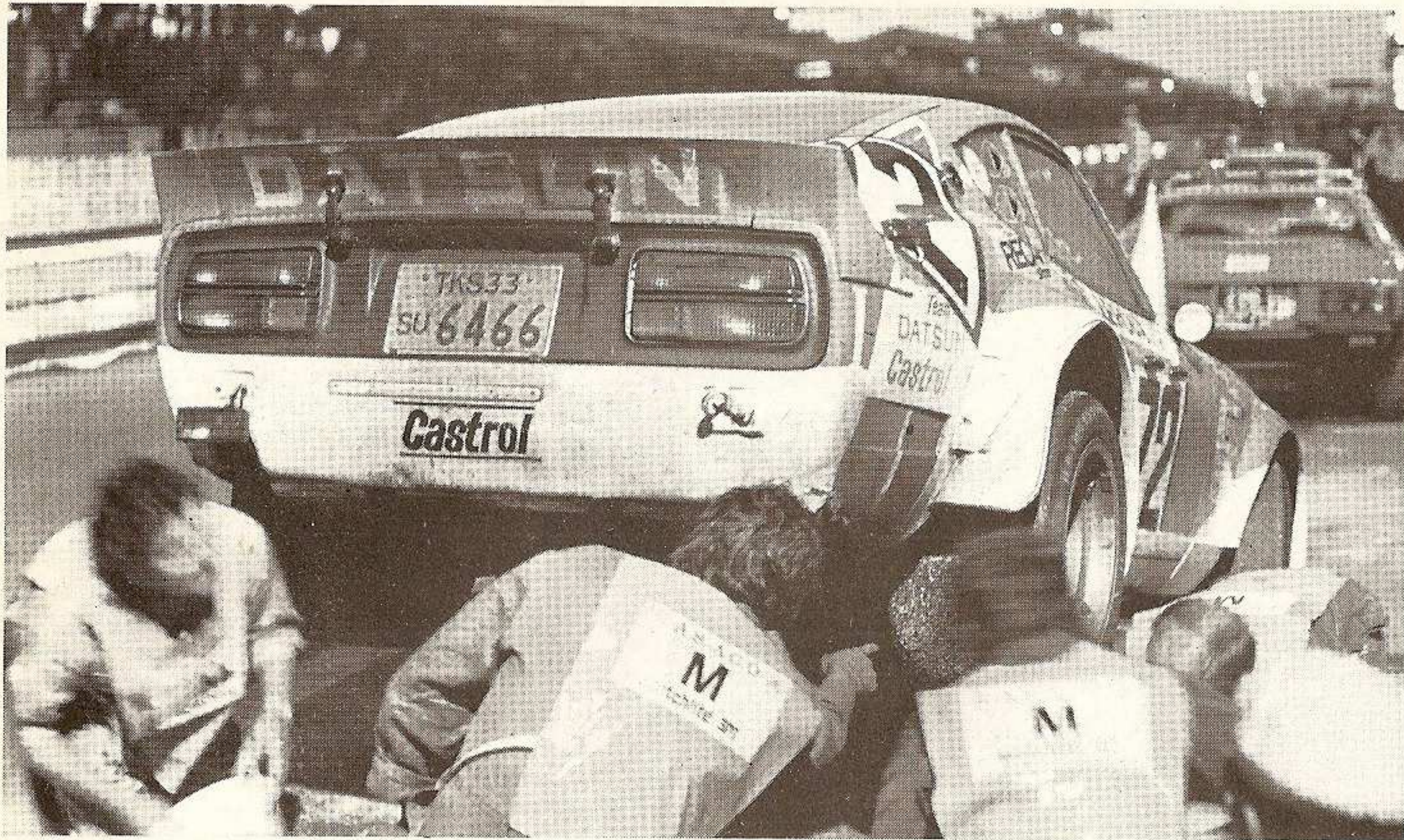
A sinistra, ammessa al via per il forfait delle Nart, questa Datsun ha dovuto cambiare due volte il differenziale. Sopra, il cambio dell'alternatore sulla Gulf di Jaussaud. Era il telaio che vibrava
