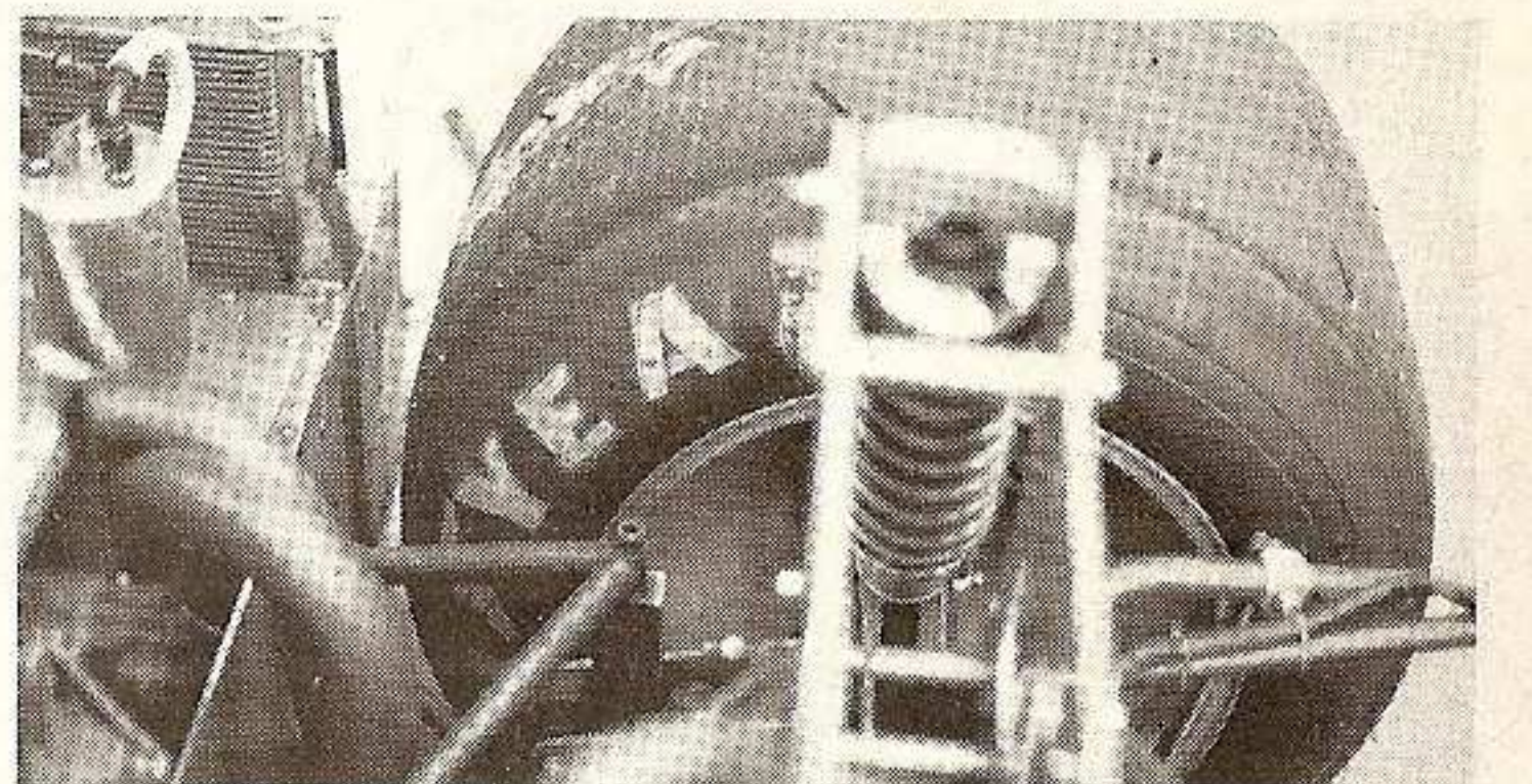
La singolare sospensione posteriore della Lola T 380. Il gruppo molla-ammortizzatore è molto in alto, sopra i montanti, che dal canto loro sono guidati non da puntoni, ma da una slitta a rulli
