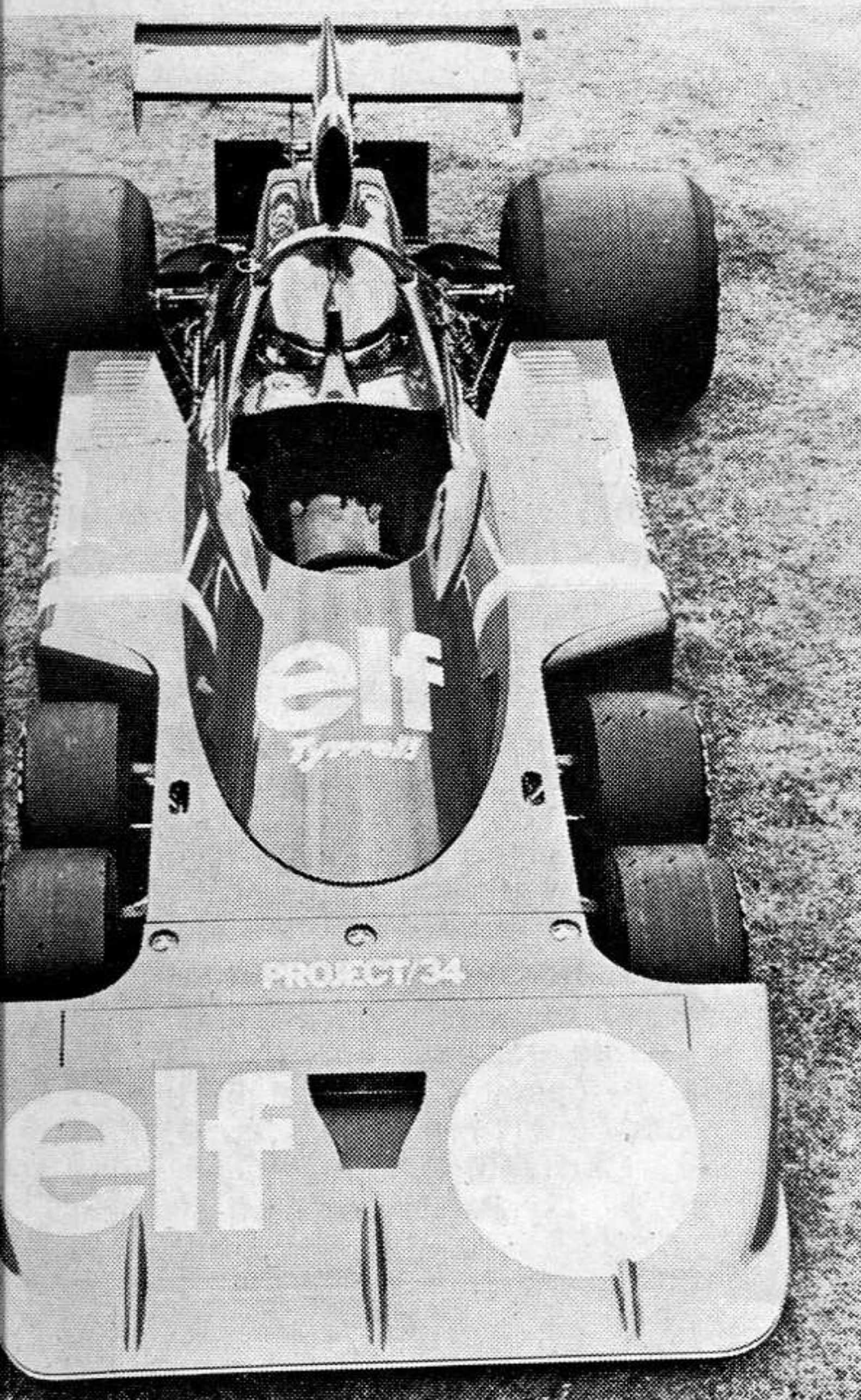
Elf Tyrrell designer Derek Gardner. Il progettista di Tyrrell, aveva questa idea per la testa fin dal 1969. Sotto, il profilatissimo frontale del «progetto 34». Le quattro ruotine sono tutte carenate
